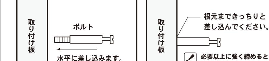
取り付ける板に「ボルト」を水平にし、ネジを締める要領で差し込みます。
