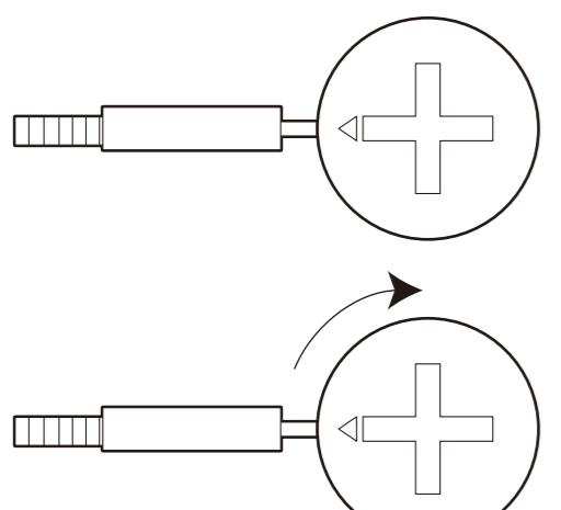
■カムロックナットをマイナスドライバーで時計回りに固くなるまで締め付ける。
