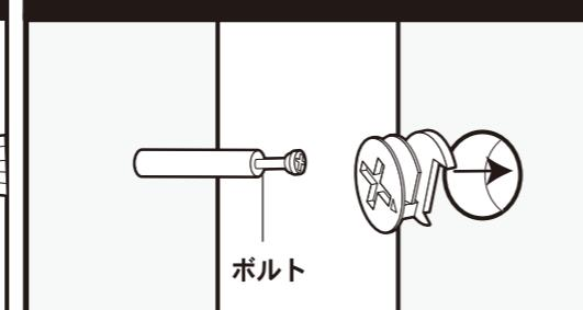
取り付ける板同士を水平にし、「ナット」の△が「ボルト」の方に向くようにしてはめ込んでください。
