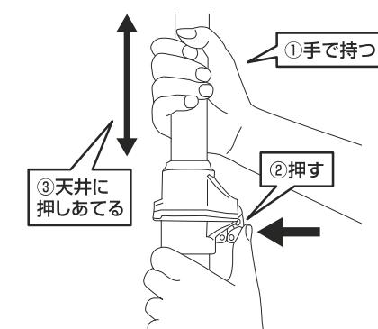
上部パイプを手で持ち、ワントッチボタンを押すと上部パイプが伸縮自在になり、ワントッチボタンから指を離すと上部パイプが固定されます。
