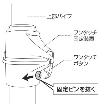
ポールを設置する前に、ワントッチ固定装置についている固定ピンを抜き取ります。
