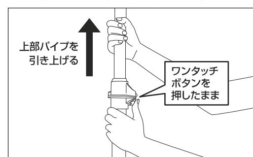
③天井に接したら、スイッチから手を放し、上部は上方向に、下部は下方向に、力を入れて引っ張ります。固定されたら、横方向に揺すってしっかりと固定されていることを確認してください。
