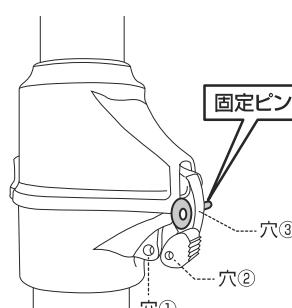
組み立て終わったら、固定pinを穴③に差し込みます。パイプ落下防止となります。
