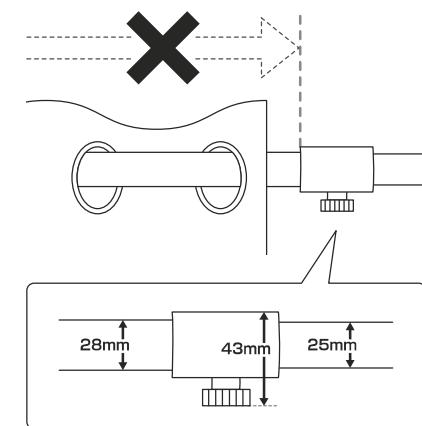
カーテンレールバーの伸縮部は43mmありますので、内径43mm以下のハトメ金具は通せません。内径43mm以上のものをご使用いただくか、両開き用のハトメカーテンをおすすめいたします。
