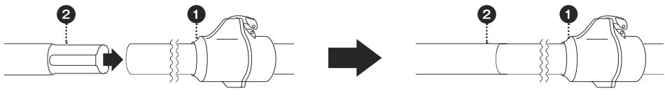
①ポールセットの先端に、②連結ポールの溝がついた方を差し込み、突き当たるまで押し込みしっかりと連結させます。
