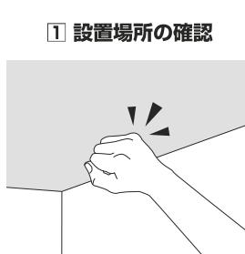
設置前に必ず天井・床の強度を確認ください。天井の強度が弱い際にはサンなどのある位置に取り付けるか、市販のあて板をご利用ください。取り付け・取り外し時の天井・床への損傷については責任を負いかねます。
