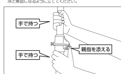
②上部パイプを持ったままワントッチボタンを押し、ワントッチボタンを押したまま天井に接するまで上部パイプを引き上げます。
