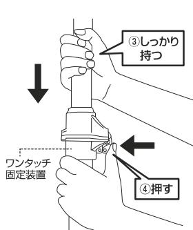
③ 上部パイプを持ちながら、④ワンタッチボタンを押してください。上部パイプを持たずにワンタッチボタンを押すと、上部パイプが急に落ちて大変危険です。
