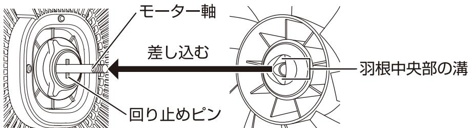
モーター軸の回り止めピンに、羽根中央部の溝を合わせて差し込みます。
