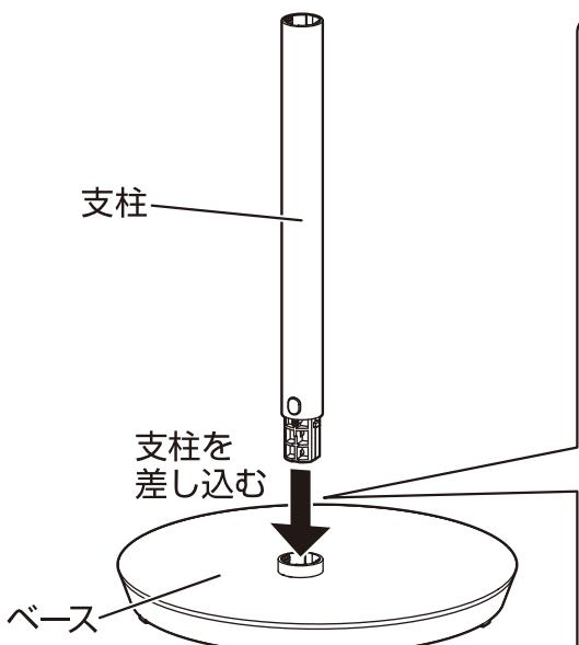
差し込み部と差し込み穴の平らな面を合わせて差し込みます。
