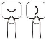
上下自動首振り運転中に「左右首振り」ボタンを押すか、左右自動首振り運転中に「上下首振り」ボタンを押すと上下左右自動首振り運転をします。
