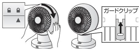
⑥▲を🔒に合わせてガードをはめ込み、▲を🔒に合わせるガードクリップを閉じ、ガードを固定する
