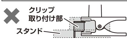
クリップ取り付け部の先端を挟む。
