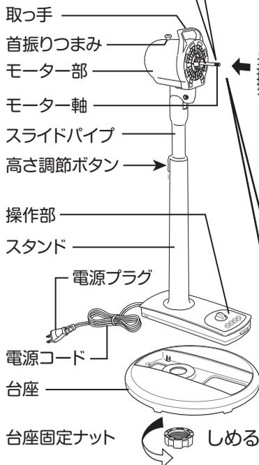
組立て前にモーター軸からナットと保護キャップ、スピナーを外してください。 注意:スピナーは逆ネジになっています。
