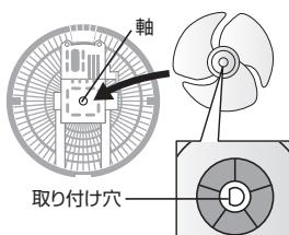
⑤羽根の取り付け穴(上図)の向きに注意しながら、軸と取り付け穴を合わせて羽根を取り付け、スピナーラーを左に回し羽根を固定する
