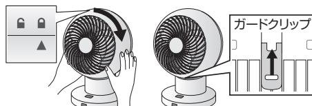
⑥▲を■に合わせてガードをはめ込み、▲を■に合わせるガードクリップを閉じ、ガードを固定する
