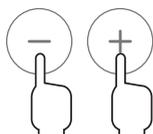
プラスボタンに触れると風量が強くなり、マイナスボタンに触れると風量が弱くなります。風量は8段階の切り換えができ、風量に応じて風量ランプの点灯が増減します。
