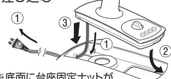
\*底面に台座固定ナットが付いていますので、先に取り外してください。
