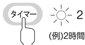
タイマーボタンを押すと、切タイマーがセットされ、押すごとに設定時間がかわり、設定時間に応じたランプが点灯します。(時間は1・2・4時間に設定できます)
