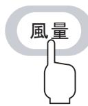
風量ボタンを押すごとに風の強さがかわり、風量に応じたランプが点灯します。リズムは、風量をランダムに変化させる運転になります。
