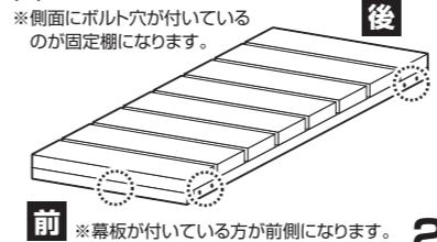
※側面にボルト穴が付いているのが固定棚になります。
