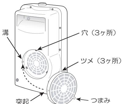
フィルター枠の突起を本体の溝に
