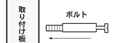
取り付ける板に「ボルト」を水平に
