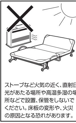
ストーブなど火気の近く、直射日光がある場所や高温多湿の場所などで設置、保管しないでください。床板がずれたり、割れたりしてケガをする恐れがあります。
