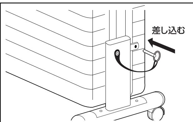
※開閉作業の際は、必ず左右のストッパーpinを抜いてから行ってください。
