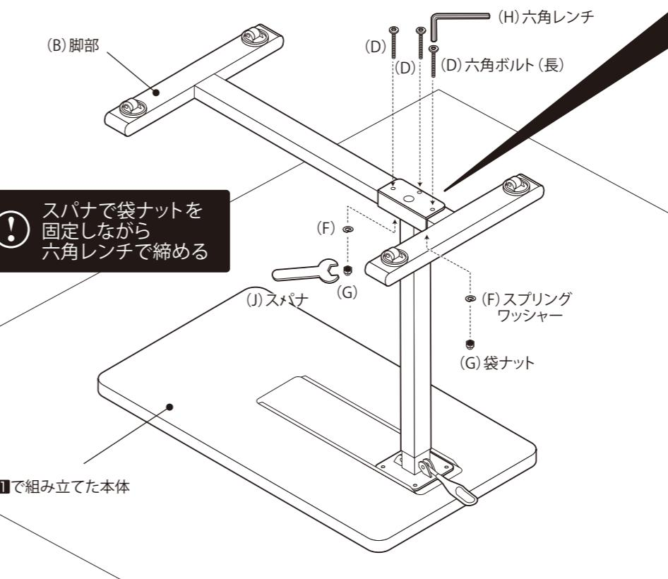
柱部の凹みに脚部のパイプをしっかりとはさみこんでからボルト止めしてください。
