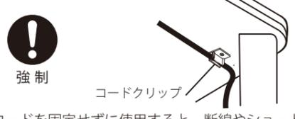
強制</p> <p>電源コードを固定せずに使用すると、断線やショートを引き起こし、火災や感電、故障の原因になります。</p>                |
