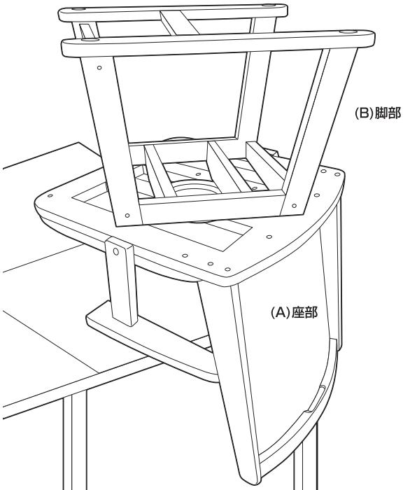
3 脚部と座部のボルト穴の位置を合わせ、座部に脚部を固定します。
