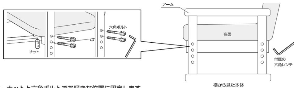
椅子を裏返して、ナットと六角ボルトでお好きな位置に固定します。4ヶ所同様に固定してください。
