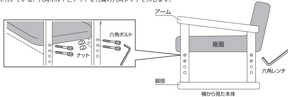
②椅子を裏返して、ナットと六角ボルトでお好きな位置に固定します。4ヶ所同様に固定してください。
