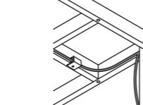
電源コードを固定せずに使用すると、断線やショートを引き起こし、火災や感電、故障の原因になります。
