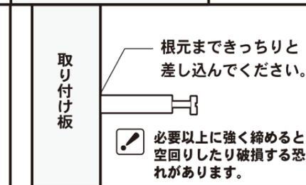
取り付ける板同士を水平にし、「ナット」の△が「ボルト」の方に向くようにしてはめ込んでください。
