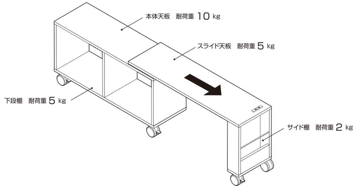
**!** **注意** スライドさせて使用する際は重なり幅を30cm程度確保してください。重なり幅が狭すぎる場合は製品の強度や安定性が低下する恐れがあります。
