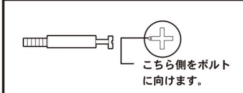
取り付ける板に「ボルト」を水平にし、ネジを締める要領で差し込みます。
