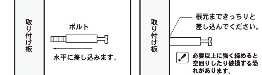
取り付ける板に「ボルト」を水平に
