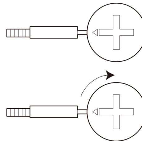
■カムロックナットをマイナスドライバーで時計回りに固くなるまで締め付ける。
