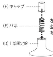
左図のように(D)上部固定盤に(E)バネ、(F)キャップを入れます。
