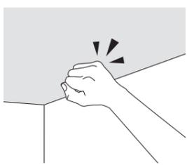
設置前に必ず天井・床の強度を確認ください。天井の強度が弱い際にはサンなどのある位置に取り付けるか、市販のあて板をご利用ください。取り付け・取り外し時の天井・床への損傷については責任を負いかねます。
