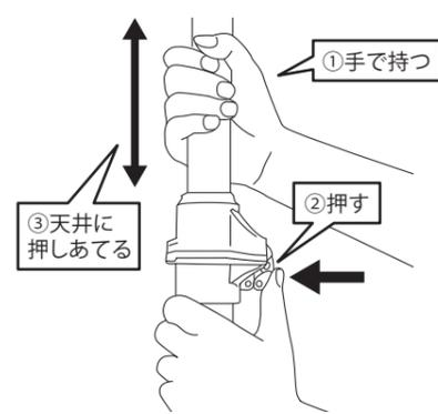
上部パイプを手で持ち、ワンタッチボタンを押すと上部パイプが伸縮自在になり、ワンタッチボタンから指を離すと上部パイプが固定されます。
