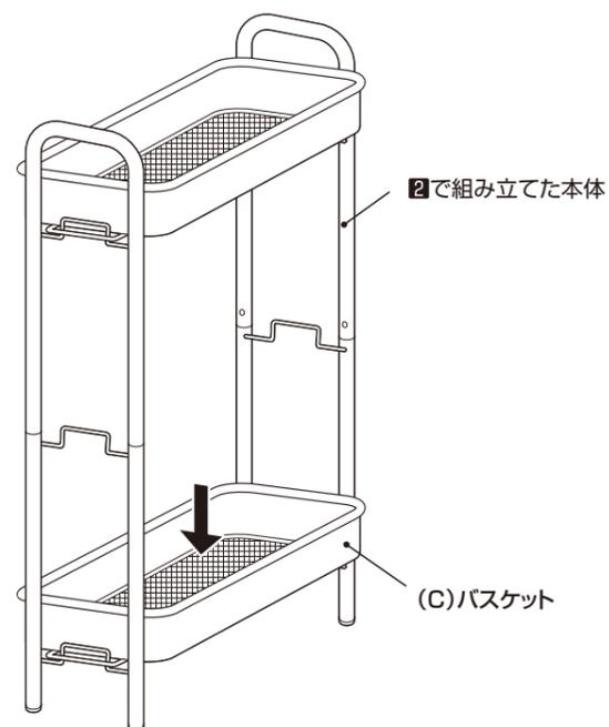
**4** 組み立てた本体に、同じ要領で残りのバスケットを取り付けます。
