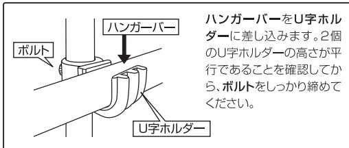
ハンガーバーをU字ホルダーに差し込みます。2個のU字ホルダーの高さが平行であることを確認してから、ボルトをしっかりと締めてください。
