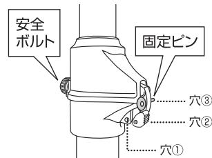
組み立て終わったら、固定pinを穴③に差し込み、背面に安全boltを差し込み、最後までしっかりとねじ込んでください。パイプ落下防止となります。
