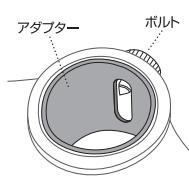
アダプターの穴に、ブラケットのボルトが通るように設置してください。
