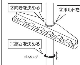
①ゴムリングを上下にずらして高さを決め、②プラケットを回して向きを調節し、位置が決まったら、③ボルトをしっかりと締めてください。
