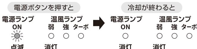
冷却中は電源ランプが点滅し、冷却が終わると消灯します。
