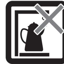
蒸気・熱によって変形・変色の原因になりますのでスライド棚は引き出してご使用ください
