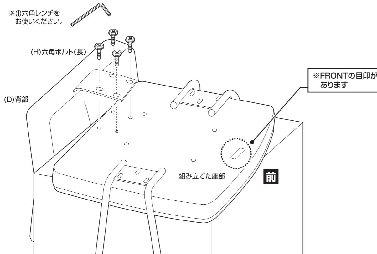
5 組み立てた脚部に、組み立てた本体を取り付けます。
