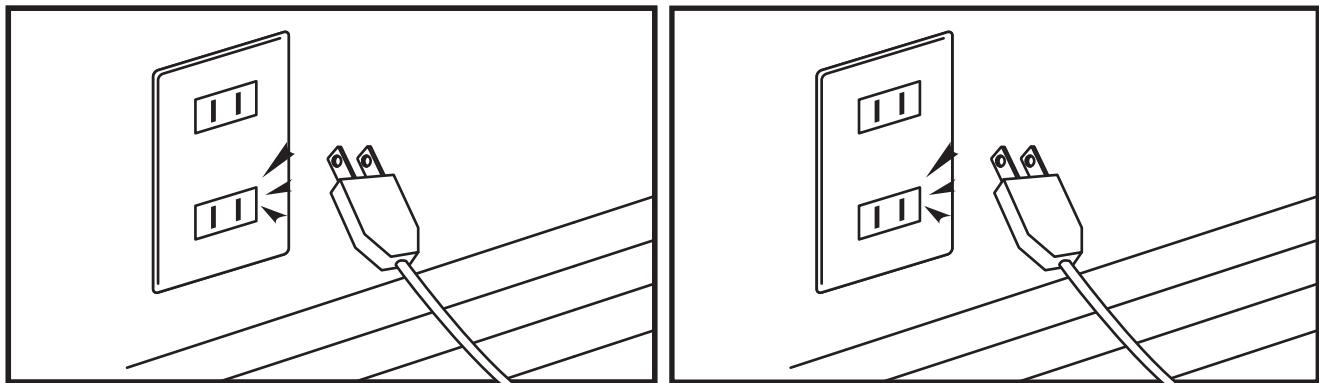
移動の際やお手入れの際は、必ず電源プラグを抜長時間使わないときは、必ず電源プラグを抜いてください。
