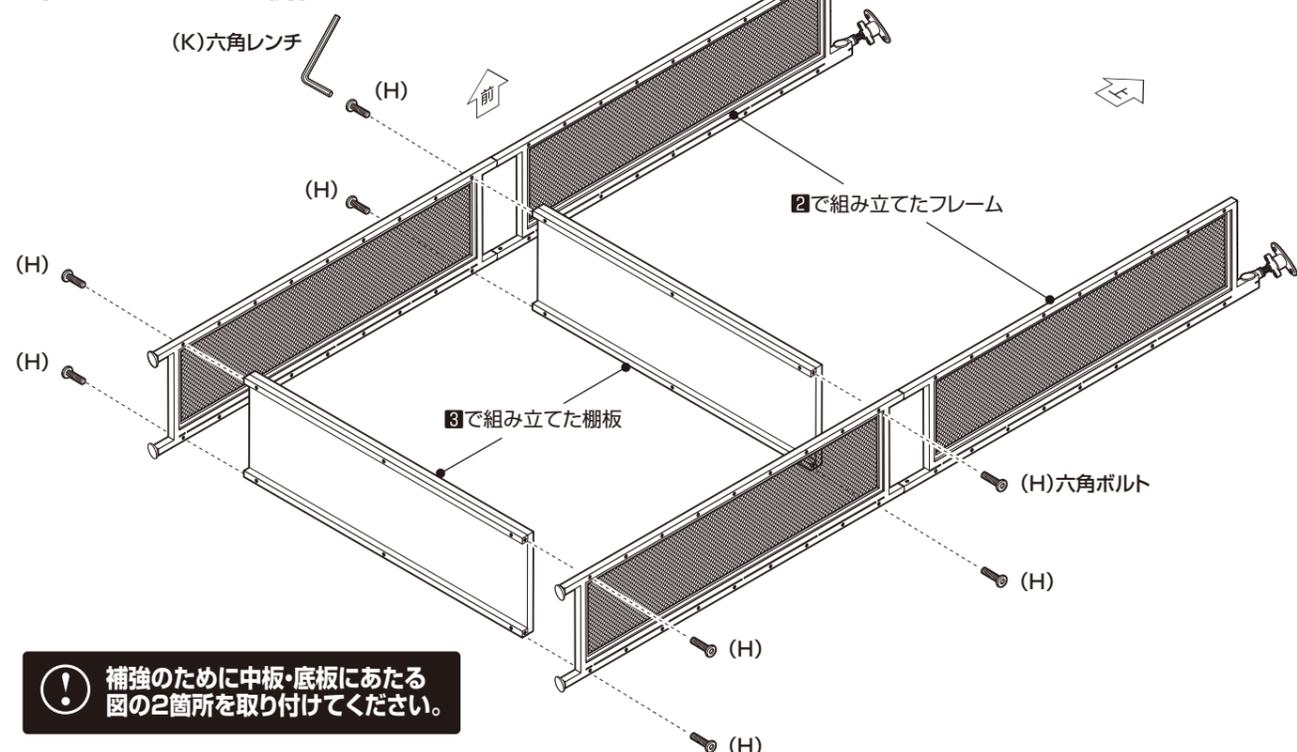
補強のために中板・底板にあたる箇所の2箇所を取り付けてください。
