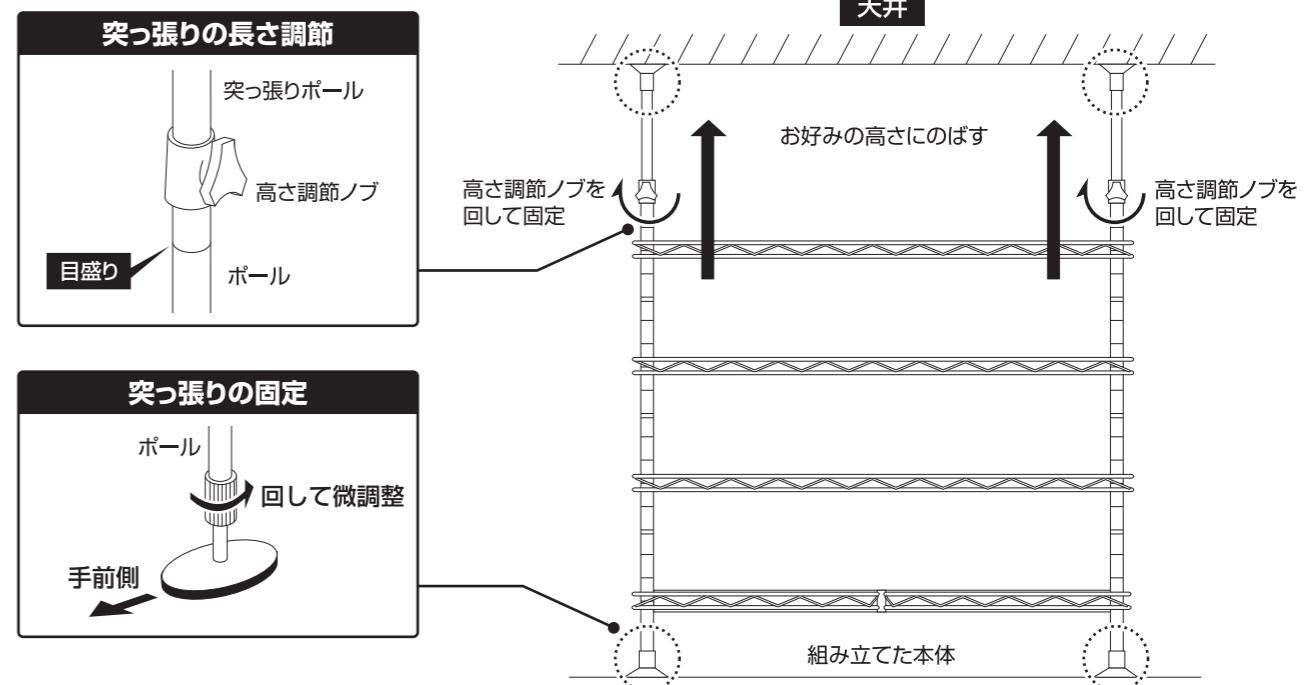
**4 組み立てた本体に、高さ調節ノブと突っ張りポールを取り付けます。**
