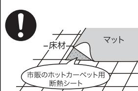
断熱をしないと、床材の変色・変形・割れなどの原因となります。
