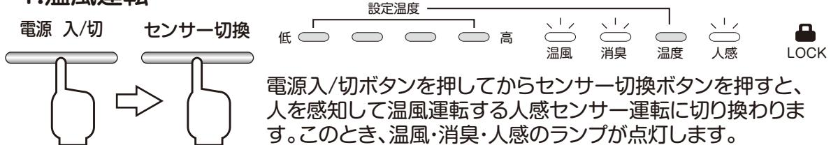
電源入/切ボタンを押してからセンサー切換ボタンを押すと、人を感じて温風運転する人感センサー運転に切り換わります。このとき、温風・消臭・人感のランプが点灯します。
