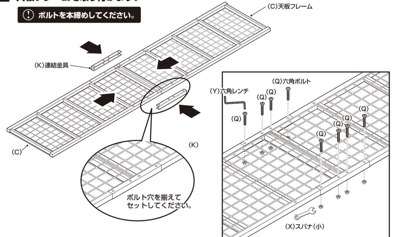
3 後ろ側デスク取り付けフレームを取り付けます。
