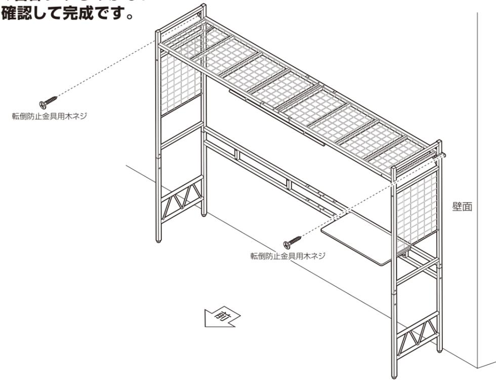
11 本体に転倒防止金具を取り付けます。(2箇所)
