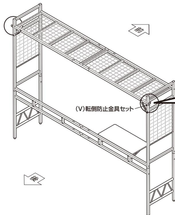
天板フレームの六角ボルト(太・長)ワッシャーセットを取り外します。
