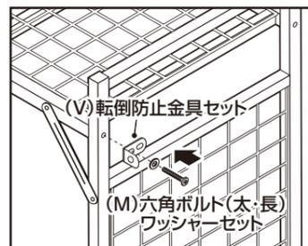
転倒防止金具と六角ボルト(太・長)ワッシャーセットを取り付けます。
