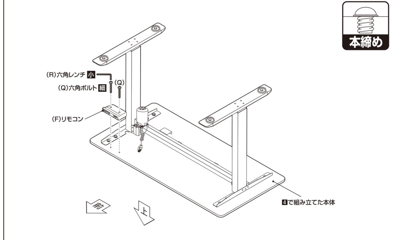
**4** ③で組み立てた本体に脚部を取り付けます。 ※ボルトは**本締め**してください。
