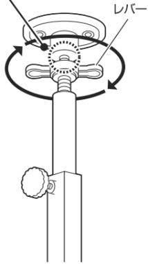
②次に調節ノブをゆるめ、突っ張りポールをのぼし、天井にあててから調節ノブを固定します。
