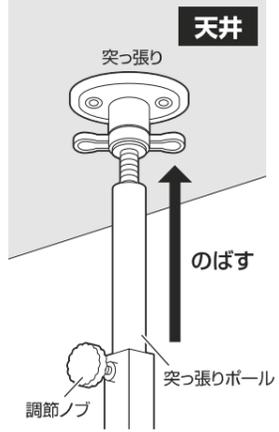
③レバーを反時計回りに回して、天井と突っ張りポールを固定します。
