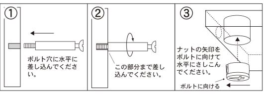
①側板のボルト受けに水平に して、カムロックボルトを差 し込んでください。
