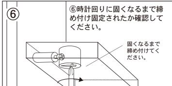
ナットの矢印をボルトに向けることによ ってナットのへこみ部分にボルトのヘッ ドが差し込まれます。
