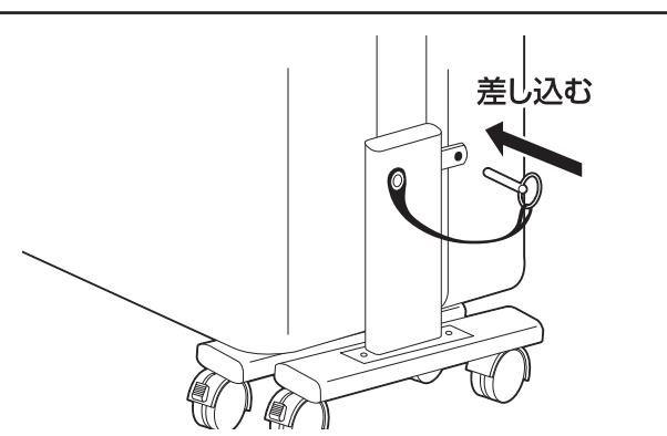
\*開閉作業の際は、必ず左右のストッパーpinを抜いてから行ってください。
