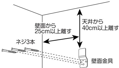
壁面に壁面金具をネジでしっかりと固定してください。
