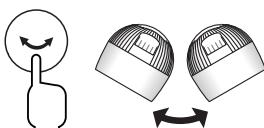
左右首振りボタンを押すと、左右(約60度)に首振り動作し、左右首振りランプが点灯します。
