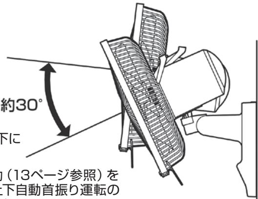
上下風向調節 手動(13ページ参照)を併用することで、上下自動首振り運転の起点をかえることができます。
