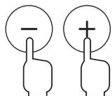
プラスボタンを押すと風量が強くなり、マイナスボタンを押すと風量が弱くなります。風量は10段階の切り換えができ、風量に応じて風量ランプの点灯が増減します。
