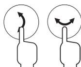
上下首振りボタンと左右首振りボタンを押すと、上下・左右首振りランプが点灯し、上下左右広範囲に風を送ります。
