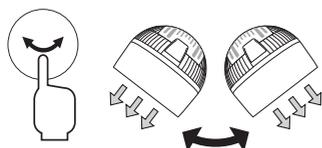
左右首振りボタンを押すと、左右首振りランプが点灯し、左右(約75度)に首振り動作します。再度押すとランプが消灯し、首振りが停止します。
