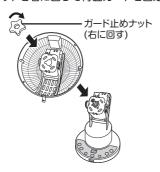
②羽根の取り付け穴の向きに注意しながら、 軸と取り付け穴を合わせて羽根を取り付ける ※羽根は取り付け穴が○真丸の方が奥側になります。
