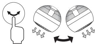
左右首振りボタンを押すと、左右(約75度)に首振り動作し、左右首振りランプが点灯します。
