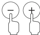
プラスボタンを押すと風量が強くなり、マイナスボタンを押すと風量が弱くなります。風量7段階の切り換えができ、風量に応じて風量ランプの点灯が増減します。
