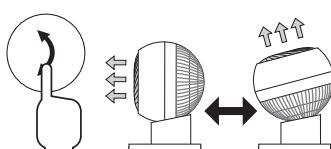
上下首振りボタンを押すと、上下(約75度)に首振り動作し、上下首振りランプが点灯します。
