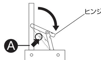
ヒンジをA矢印の方向に折り曲げ、脚部を収納します。
