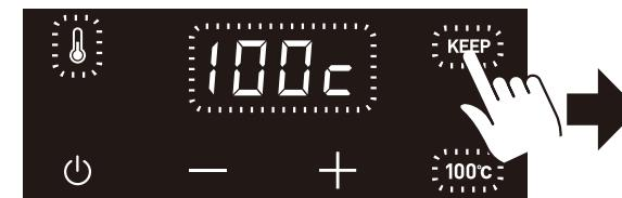
各スイッチで温度を設定後、または加熱中や加熱後に保温スイッチをタッチすると保温スイッチが点滅します。
