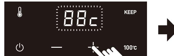
温度設定スイッチをタッチすると設定中の温度が点滅します。
