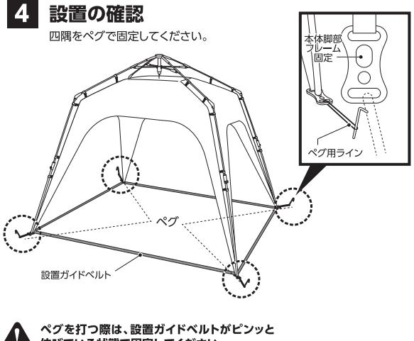
**!** ペグを打つ際は、設置ガイドベルトがピンッと伸びている状態で固定してください。
