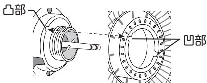
後ガードの凹部に本体の凸部を合わせる。(2ヶ所)
