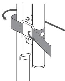
3 上部ポールの金具を完全に引き出し、横に倒してください。
