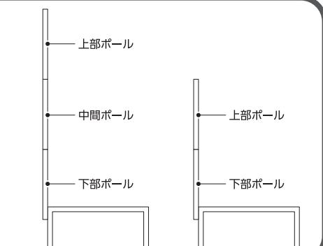
1 テーブル脚部のポール取付け穴に、下部ポールのポール取付突起を接続してください。
