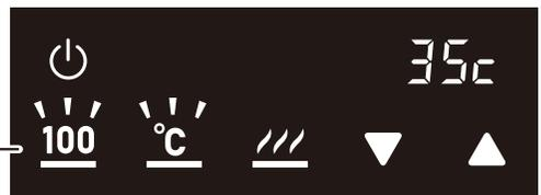
加熱されて水温が上がると表示部の水温も上がります。(上図は水温が35°Cのとき)
