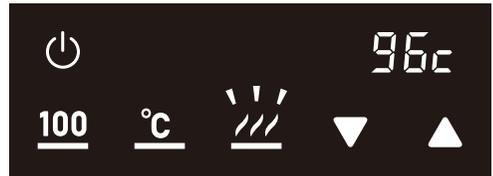
保温スイッチが点滅し、設定温度で保温します。(上図は100℃で保温を設定したため96℃前後で保温)
