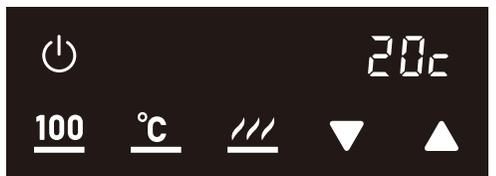
各スイッチが点灯し、表示部に水温を表示します。(上図は水温が20℃のとき)
