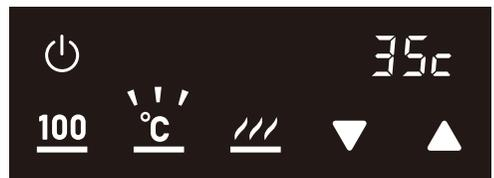
加熱されて水温が上がると表示部の水温も上がります。（上図は水温が35℃のとき）
