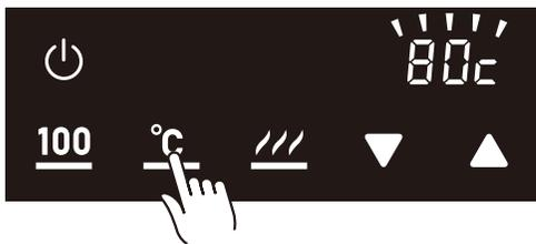
温度選択スイッチをタッチしていくと、表示部に「80c」が点滅表示されます。「80c」が5回点滅すると、温度が設定されます。
